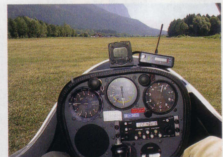
Die Instrumente: Oben, Kompass und FLARM (rechts). Mitte, Variometer, Fahrtmesser, Höhenmesser. Funkgerät und ganz unten der Wendezweiger
